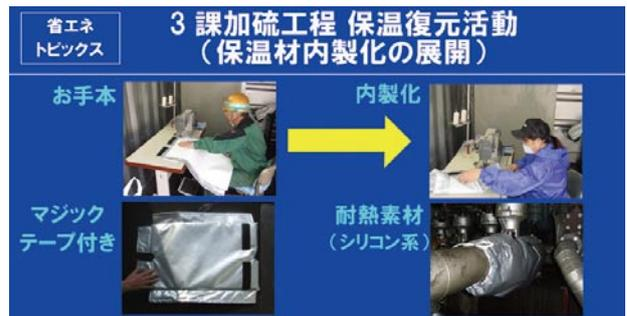
ブルーシートの記載例。加硫工程における保温材内製化(三重工場)。
