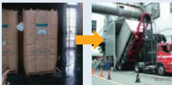
カーボンブラック容器をジャンボバック(左)からバルクライナー(右)に変更することで、廃材(木製パレット、ポリエチレンシート)の量を、カーボンブラック10トン当たり290kgから10kgと大幅に削減しました。
