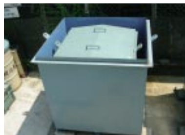
PCB廃棄物は容器を二重にし、厳重に保管
