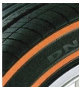
低ノイズサイドグループ。サイドウォールの走行時に振動する部分に溝をつくり、クルマの持つ振動周波数との共振を避け、ロードノイズを低減します。
