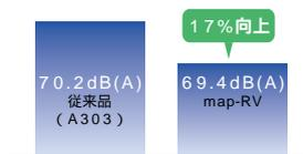
テストコース内ロードノイズ路走行時の車内音を測定。横浜ゴムテストコースロードノイズ路、路面：アスファルト、マイク位置：運転席窓側、速度：60km/h、タイヤサイズ：205/65R15 94H、リムサイズ：15 x 61/2JJ、空気圧：230kPa、車両：トヨタエスティマ、乗車条件：2名
